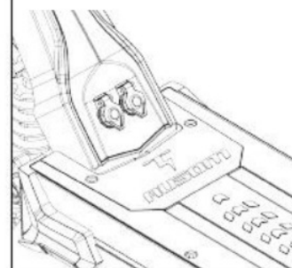
A) A töltőcsatlakozó az állófelület előtt, fedél alatt található.
